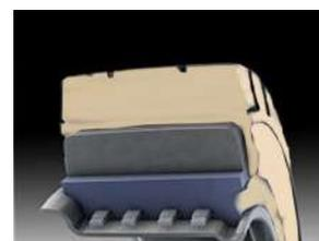
Les pneus pleins ne contiennent ni air ni autres gaz. Ils sont constitués de plusieurs couches réalisées dans des composés particuliers de caoutchouc ou acier. Les pneus pleins offrent une stabilité et une résistance aux crevaisons extraordinaires ainsi qu'une capacité de charge élevée. Ces pneus qui ne nécessitent aucun entretien sont essentiellement utilisés pour les chariots élévateurs et autres véhicules industriels.
