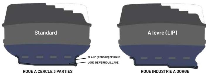
La forme **standard (du talon)** se monte à la presse sur une roue boulonnée ou une roue à cercle standard avec flanc et jonc de verrouillage démontable.
